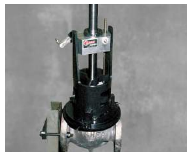
Станок для ремонта шаровых затворов и регулирующих клапанов VM8000
