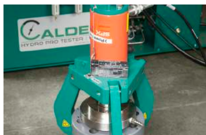
Гидравлическое уплотнение фланца HFS HYDROPRO™
